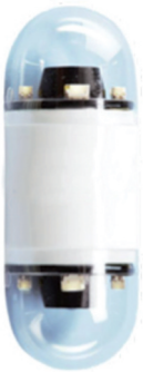
FIGURA 2: videocapsula per lo studio del colon. Si tratta di un dispositivo con la forma che ricorda una grossa compressa (dimensioni: 11.6 x 31.5 mm). Essa è dotata di 2 telecamere (una anteriore ed una posteriore) in grado di scattare 4 fotografie al secondo. Si tratta di un dispositivo monouso alimentato da una batteria interna. Le immagini catturate durante la progressione della video capsula nel colon vengono inviate ad un registratore esterno dal quale vengono poi scaricate su un computer dedicato per la lettura da parte del Medico.
